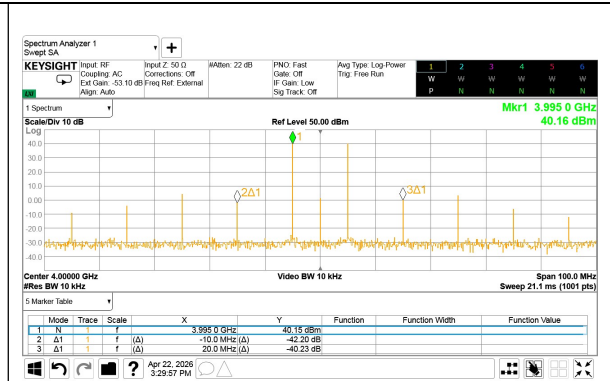
2 tones 20W average 4000MHz 10MHz spacing 48V/1.57A
