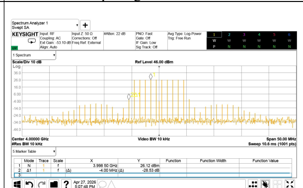
10 tones 1MHz spacing 4W average 4000MHz 48V/0.54A
